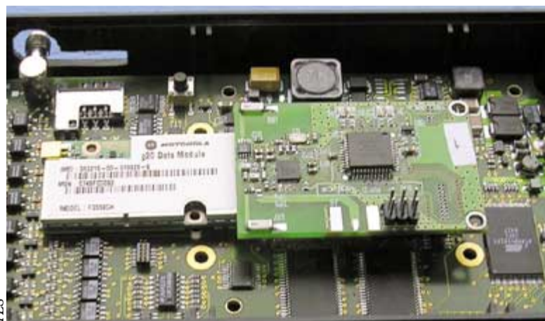
Véritable centrale d'information, ce boîtier permet de piloter par SMS une machine télécommandée par un module ZigBee.
