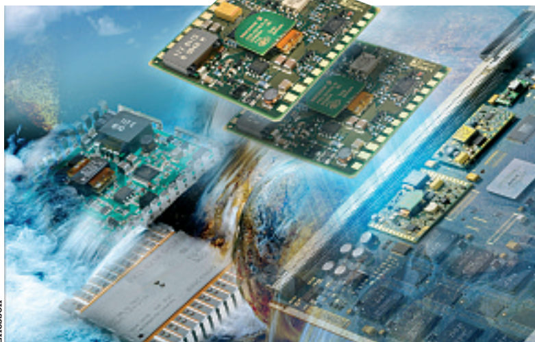
Ce module de puissance est doté de composants sur une seule face pour en réduire le coût de production et repose sur une technique de connexion carte à carte évitant le surmoulage.
