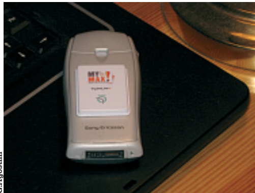
Une fois activé, le sticker NFC développé par Twinlinx communique avec le terminal via une liaison Bluetooth. Commercialisation prévue en 2009.
