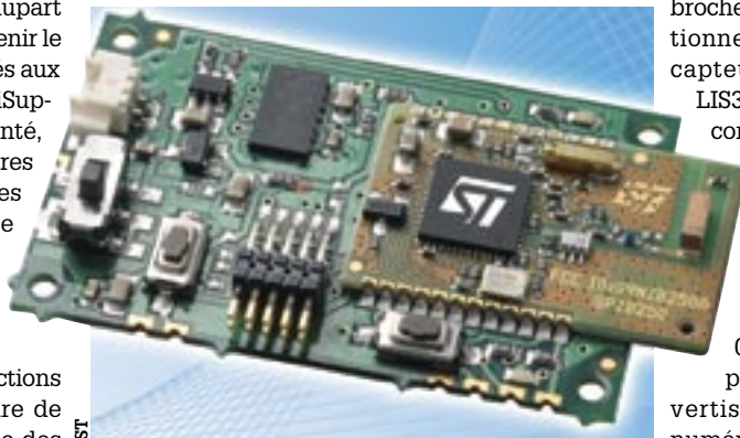
Ce module prêt à l'emploi de dimensions réduites simplifie la mise en œuvre d'un réseau de capteurs sans fil.
