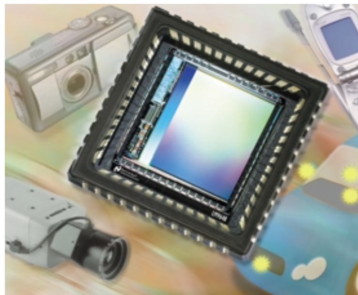
National Semiconductor propose une gamme complète de capteurs d'images Cmos. Ainsi ce modèle couleur LM9648 de définition SXGA+, destiné aux caméras embarquées.
