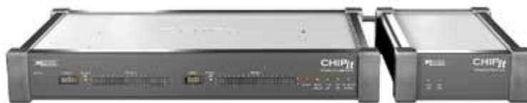
Les plates-formes de prototypage sur FPGA complexes sont de plus en plus utilisées par les concepteurs d'Asic (doc. ProDesign).
