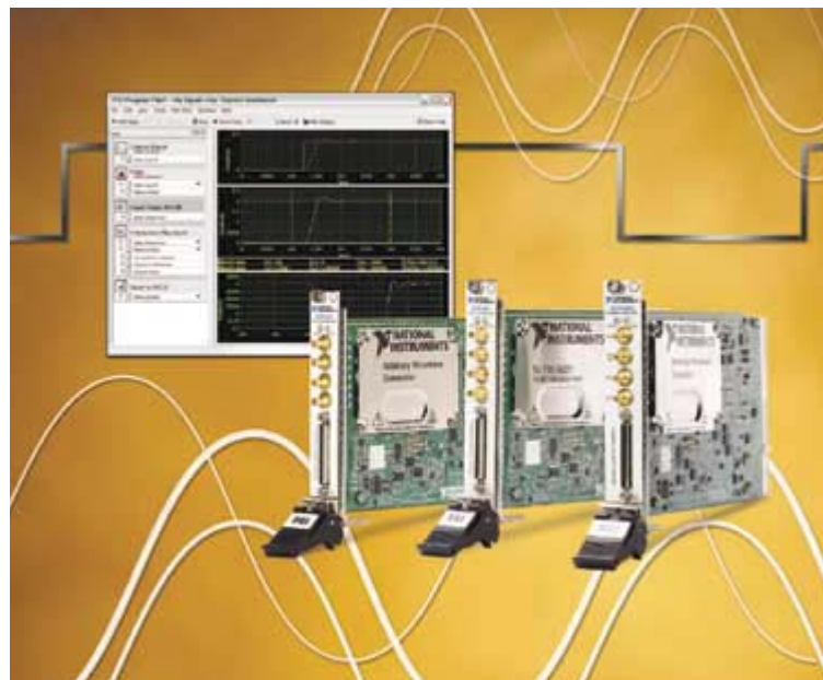
L'architecture SMC des générateurs de signaux arbitraires PXI-542x et PXI-5441 de National Instruments procure une précision de synchronisation entre modules de 10 à 20 ps.
