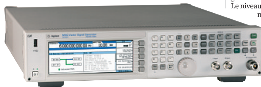
De hauteur limitée à 2U, le générateur de signaux vectoriels MXG N5182A d'Agilent dispose d'une grande qualité de modulation numérique, dont témoigne son erreur vectorielle de 1,2% rms sur signaux W-CDMA et son ACLR qui atteint 71 dB.
