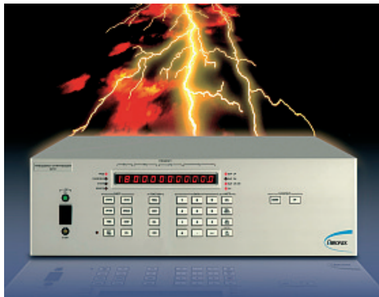
Mettant en œuvre un procédé de synthèse analogique directe, le 2218 d'Aeroflex se distingue par son temps de commutation en fréquence inférieur à 1 \mu s. Il présente une ergonomie un peu spartiate caractéristique d'un marché de niche.
